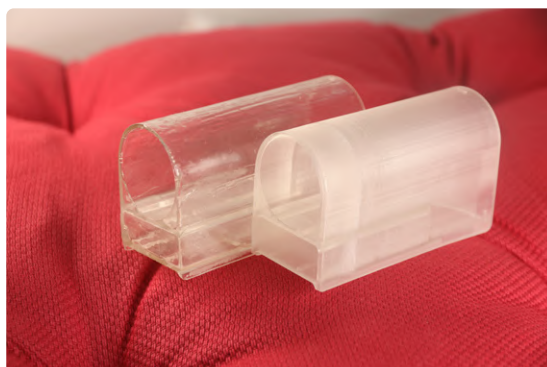
Figuur 8. 3D-geprinte behuizingen voor het project: onbewerkt (links) en afgewerkt met een glanzende en transparante laklaag (rechts).
