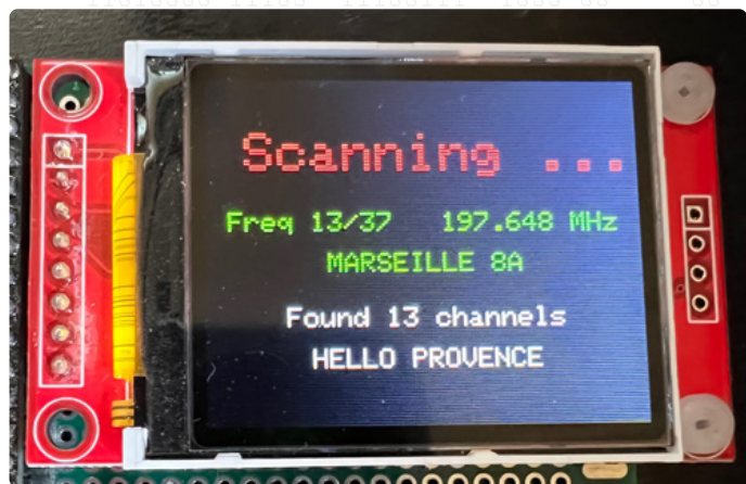
Figuur 6. Hier zien we dat de multiplex MARSEILLE 8A is gevonden en dat deze 13 stations bevat. HELLO PROVENCE is het eerste.
