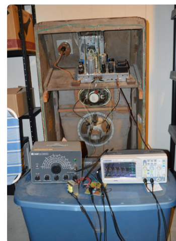
Figuur 10. Hier wordt de lage-Q versterker gebruikt om de resonantiefrequentie te meten van een raamantenne voor een antieke radio.
