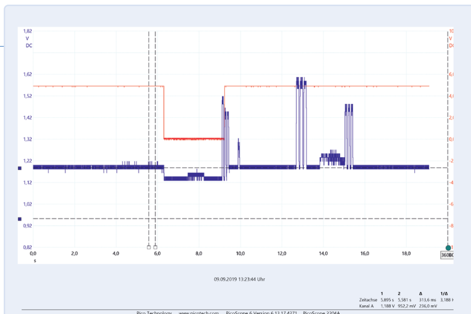
Figuur 1. De 433MHz-band is zeer druk bezet. Signalen van verschillende zendmodules zijn hier zichtbaar. De pulsreeks in het midden is degene die we willen.
