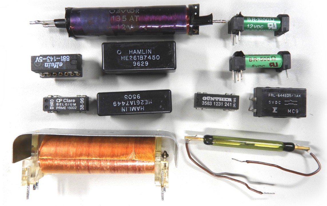
Figuur 2. Een verzameling reed-relais. Linksonder een wisselschakelaar (twee contacten aan de linkerkant). Rechtsonder is een kaal reed te zien. De rest illustreert de grote verscheidenheid aan afmetingen en behuizingen die verkrijgbaar zijn.
