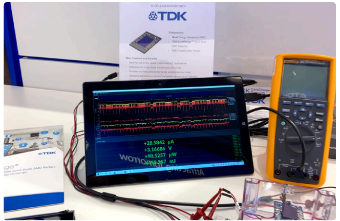
Figuur 3. De oplaadbare, solid state, surface mount CeraCharge-batterij van TDK werkt met een meerlaags lithiumgebaseerde oxidestructuur.
