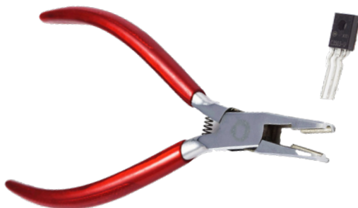
Figuur 17. Om spanningen door thermische uitzetting te voorkomen, worden de aansluitdraden van de drivertransistoren iets gebogen. Dit gaat heel gemakkelijk met de hier afgebeelde speciale tang, maar het kan ook met een rondbektang.
