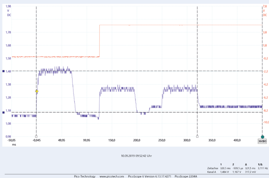
Figuur 2. Timing is cruciaal voor de selectie van de middelste puls.
