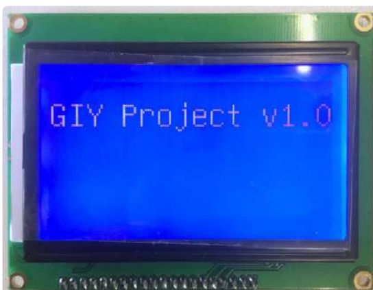
Figuur 9. Het gebruikte LC-display heeft een resolutie van 128x64 pixels en is met slechts 3 aansluitingen op het board aangesloten.
