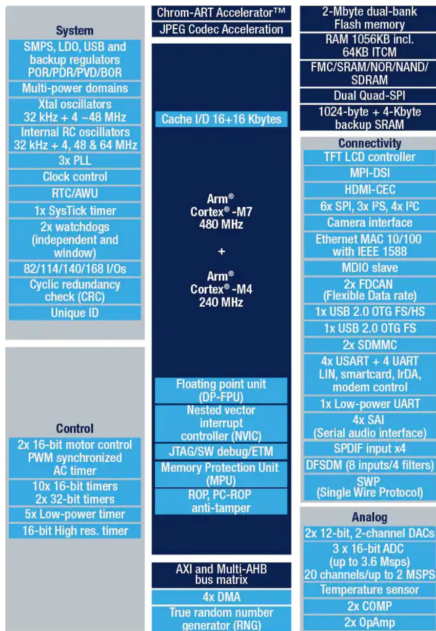
Figuur 8. Overzicht STM32H747XI (bron: STMicro, https://bit.ly/3xoRTDF ).
