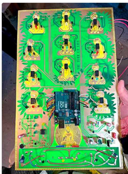
Figuur 4. Links het ontwerpbestand voor de Tree of Life in de Circuit Garden, 2022. Rechts de print met een geïntegreerde Arduino Uno (bron: Kelly Heaton).
