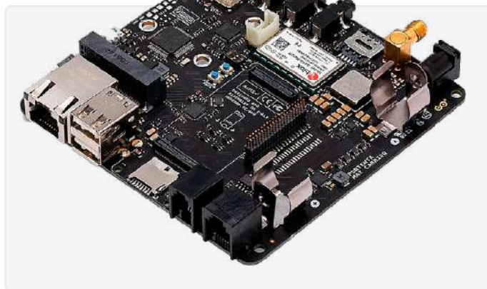
Figuur 2. Max Carrier transformeert Portenta-modules in single-board computers of referentieontwerpen die edge AI mogelijk maken voor krachtige industriële of gebouwautomatisering en robottoepassingen.
