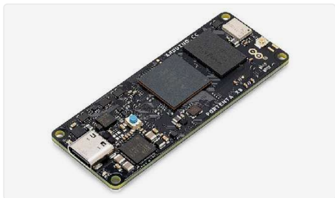
Figuur 1. Portenta X8 is een krachtige, industriële SOM met Linux OS voorgeïnstalleerd aan boord, die apparaatafhankelijke software kan draaien dankzij de modulaire container-architectuur.
