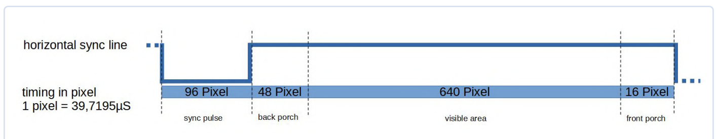
Figuur 5. Timing van een VGA-beeldlijn.
