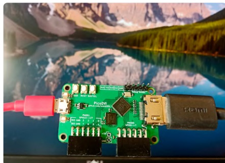
Figuur 25. PicoDVI – RP2040 met DVI-video-uitgang (bron: Wren6991 / https://elektor.link/picodviimg ).
