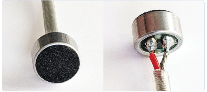
Figuur 7. Een klein elektretkapsel met een 5mm-membraan.
