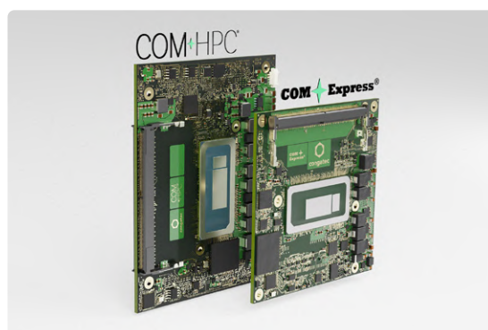
◀ Figuur 3. De nieuwste processorstechnologie zoals de high-end 13 e generatie Intel Core-processoren in BGA-behuizing monteert Congatec op zowel COM-HPC als COM Express modules.
