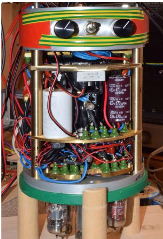
Figuur 17: Voorlopige montage van de volledige versterker, zonder de beschermende buisbehuizing.
