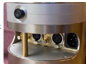
Figuur 19: Een uitsparing aan de achterzijde bevat de ingangs- en uitgangconnectoren en de netspanningsconnector.
