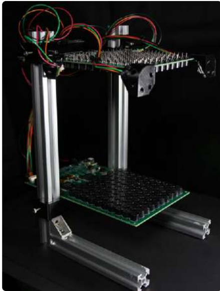
Figuur 1. Twee array's van elk 100 ultrasone transducers worden gebruikt om een piepschuim balletje te laten zweven.
