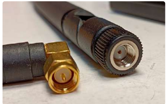
Figuur 2: Antennes met SMA-connectoren. Links is correct, en rechts dus niet, bij de Opera Cake en HackRF One.
