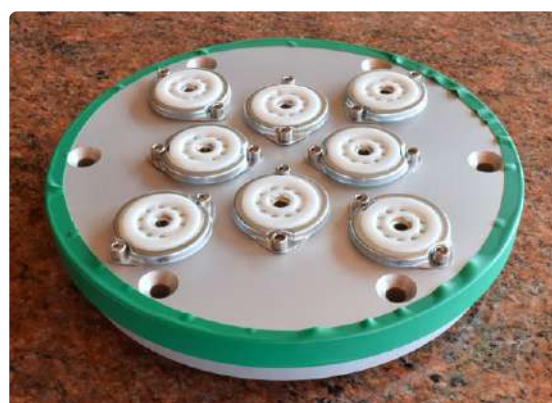
Figuur 9: Aantrekkelijke mechanische constructie voor de elektronische componenten: de voeten voor alle buizen van de stereoversterker.
