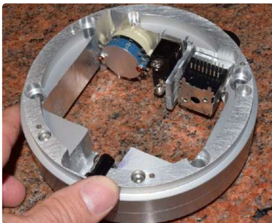
► Figuur 16: De onderdelen van de gebruikersinterface (keuzeschakelaar, aan/uit-schakelaar en volumepotmeter) zijn gemonteerd op hun eigen aluminium ring.
