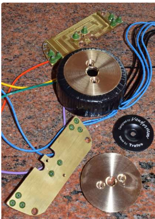
Figuur 15: Een ronde transformator voor een ronde versterker. Ook hier zijn extra mechanische onderdelen nodig voor de bevestiging.
