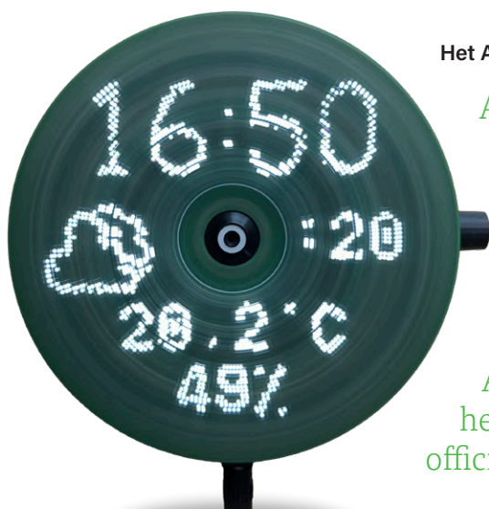
▲ Figuur 1. Roterend LED-display met tijd- en weergegevens.
