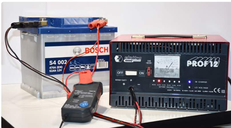
Figuur 7. De gemodificeerde acculader tijdens de test. Let op de grote laadstroom in het begin en de DC-stroomtang die is gebruikt voor metingen.
