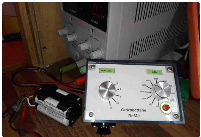
Figuur 4. De opgebouwde lader aan het werk met een accupack van vier cellen.
