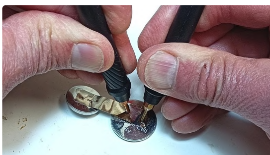
Figuur 4. Zo last u. Druk zachtjes en wacht een paar seconden.
