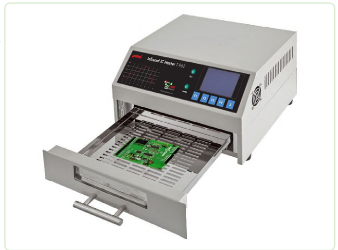
Figuur 16. De T-962 infrarood reflow-oven met speciale functies; deze is exclusief verkrijgbaar bij Elektor [9].
