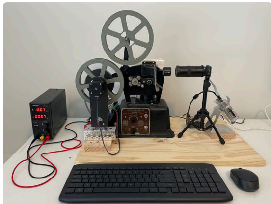
▲ Figuur 3. Opstelling van de DHZ-filmdigitizer.
