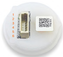
Figuur 1. De actieve zijde van de sensor (a) en de pinning van de connector aan de achterzijde (b) (bron: lab van de auteur).
