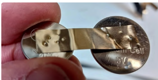
Figuur 5. Las een nikkel-contactstrip aan een knoopcel.
