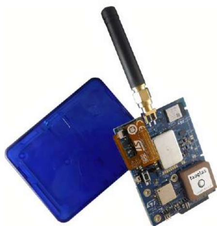
Figuur 3. De STEVAL-ASTRA1B asset tracking ontwikkelkit (bron: ST).
