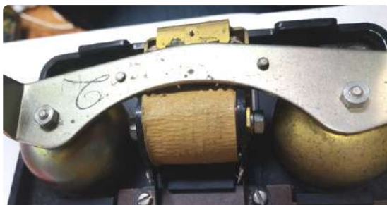
Figuur 4. Het belmechanisme van de oude telefoon.
