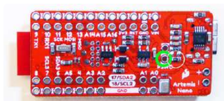
Figuur 5. Het Artemis Nano-board. R1 is wit omcirkeld. In tegenstelling tot de Thing Plus is er geen EN-connector maar een 'PSWC'-connector. TPL5111 ENABLE moet worden aangesloten op de groen omcirkelde connector nadat R1 is verwijderd. Let op: R1 zit aan de andere kant van de print, en moet worden verwijderd voordat deze wordt gemonteerd.
