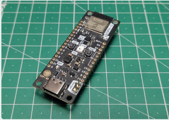
Figuur 3. De ESP32-C3 integreert een USB-gebaseerde debugmodule met een seriële interface, zodat er geen externe probe-hardware nodig is.
