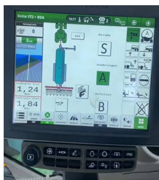
▲ Figuur 1. ISOBUS- (ISO 11783-)gebruikersinterface op een John Deere-monitor. Deze bestuurt een slurry tanker.
