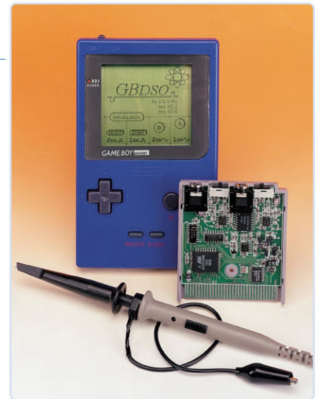
Figuur 8. De Game Boy Digitale Sampling Oscilloscoop (GBDSO).
