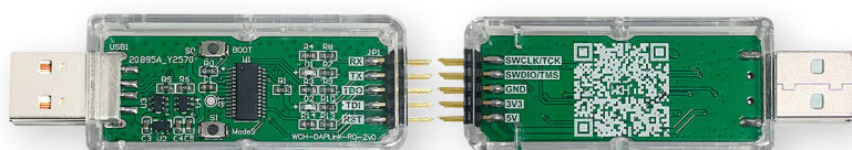
Figuur 4. WCH-Link, het tool dat wordt gebruikt voor programmeren en debuggen (bron: WCH [11]).
