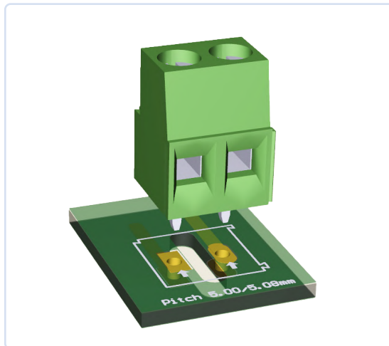
Figuur 4. Sleuven tussen pads en sporen verhoogt de isolatie op een PCB aanzienlijk; deze uitsparingen kunnen ook worden gebruikt om gebieden met grote potentiaalverschillen te scheiden.
