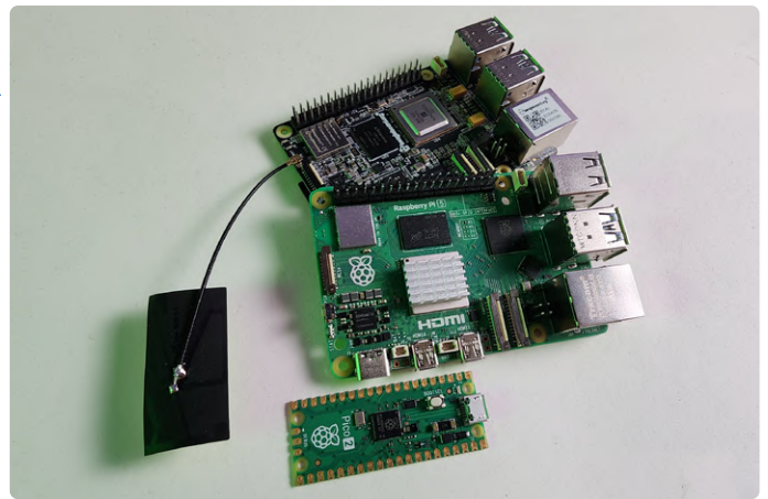
Figuur 2. BeagleY-AI, Raspberry Pi 5 en Raspberry Pi Pico 2 profiteren allemaal van edge-AI.
