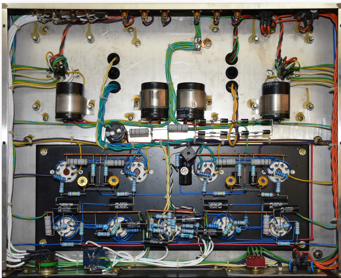
Figuur 1. Onderaanzicht van een zwevend bedrade KT-88 buizenversterker van de auteur. De onderdelen zijn netjes geplaatst, de thermische dissipatie is goed. Het gebied waar extra elektrische isolatie nodig is, kan worden herkend door de aanwezigheid van een zwarte glasvezelplaat. Voor de montage van grote componenten zoals elektrolytische condensatoren zijn afzonderlijke steunen (metalen beugels) nodig. Op sommige plaatsen zijn de componenten boven elkaar gemonteerd, wat eventuele reparaties kan bemoeilijken.
