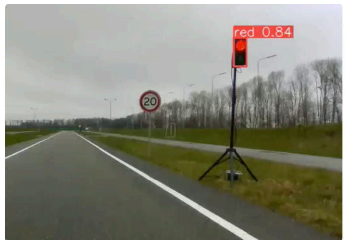
Figuur 8. YOLOv8 Rode verkeerslichtdetector met weergave van het betrouwbaarheidsniveau.
