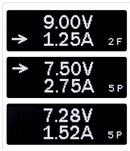
Figuur 4: Een vaste PDO (boven) laat toe de maximale stroom in te stellen in stappen van 0,25 A door aan de encoder te draaien. Na selectie van een programmeerbare PDO (midden) kun je de spannings- en stroomlimieten instellen. In dit laatste geval kan, als de uitgang actief is (onder), de spanning nog steeds in stappen van 0,1 V worden aangepast en wordt de werkelijke stroom getoond.
