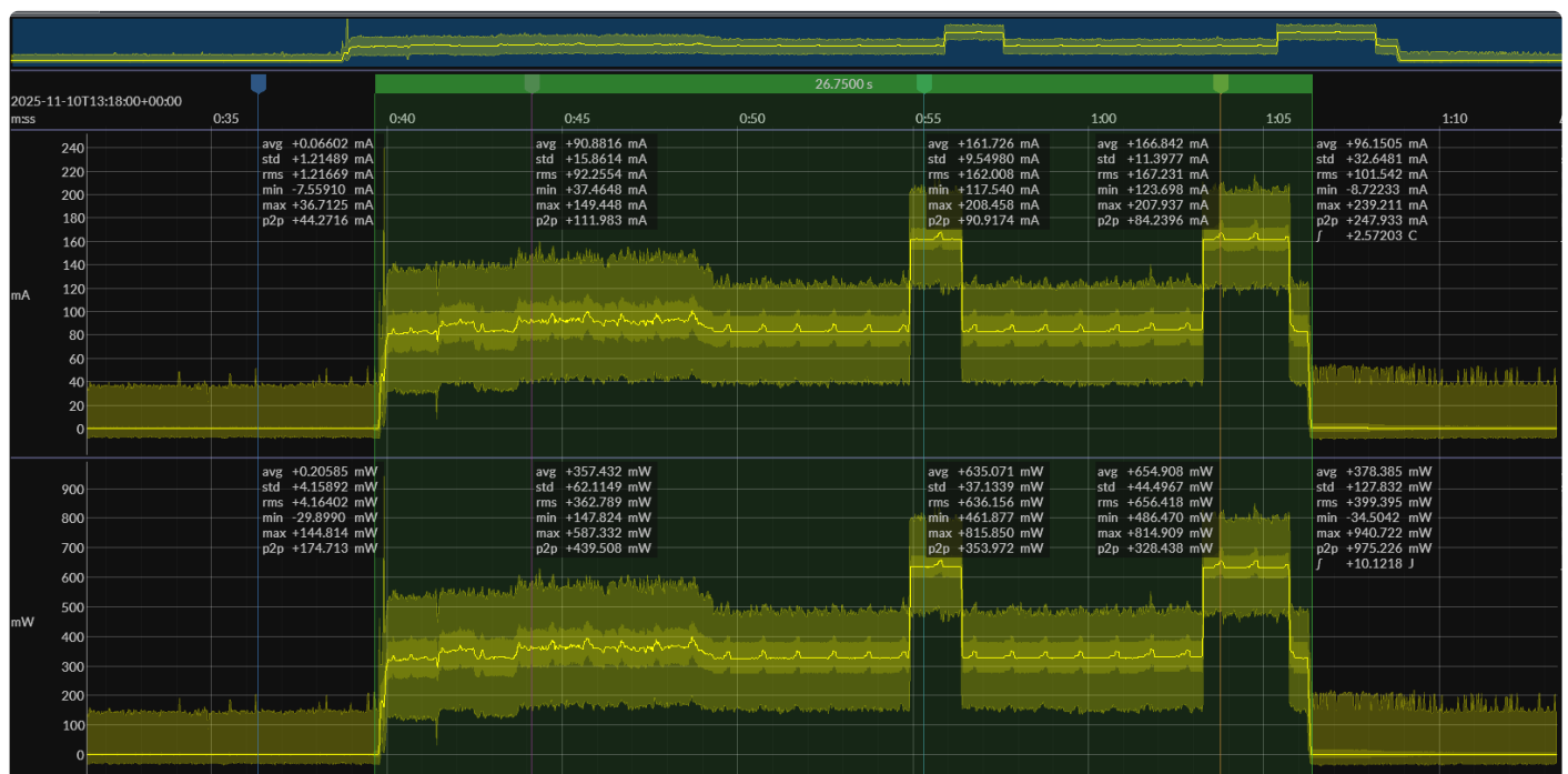
Figuur 6. Volledige wake-up cyclus-golfvorm: stroom- en vermogensgedrag bij het starten van het systeem, GPS-acquisitie, LoRaWAN-transmissie en terugkeer naar deep-sleep.
