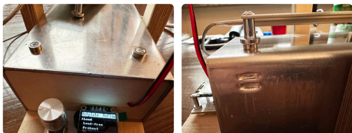
Figuur 1. De verwarmingsplaat is op veilige afstand vastgezet met neodymium-magneten.
