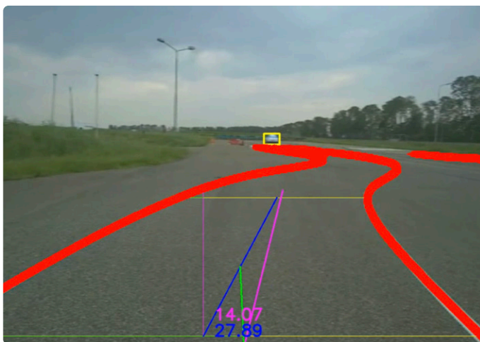
Figuur 7. YOLOPv2-lijndetectie plus onze stuurvectorberekening.
