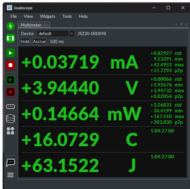
Figuur 5. Gemeten stroomprofiel van het systeem in deep-sleep modus, waarbij de ESP32-S3 en alle randapparatuur uitgeschakeld zijn via de load-switches.
