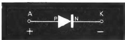
Figuur 1.1. Symbool van een diode. Let op de pijlvorm van de anode-aansluiting. Deze pijl geeft de stroomrichting aan.
